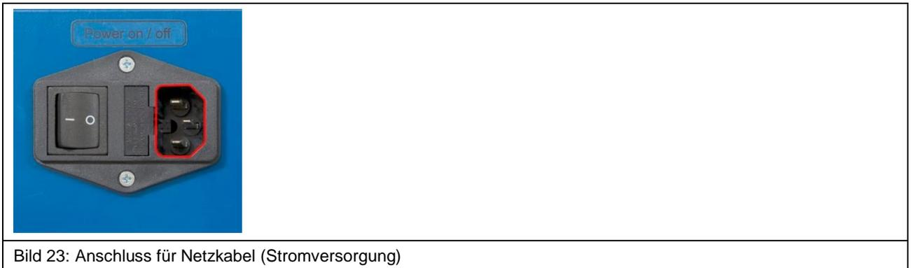
Der Kaltgeräteanschluss zur Stromversorgung befindet sich neben dem EIN-/AUS-Schalter auf der Rückseite des Scanners FLS 106.
