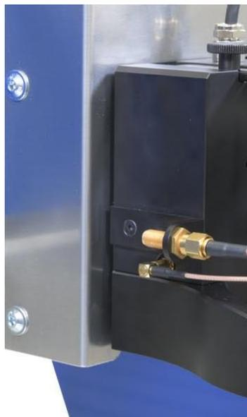
Bild 73: Kabel SSMB-SSMB angeschlossen
