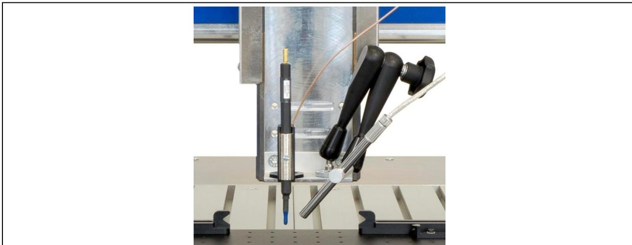
Bild 104: Die Nahfeldsonde wird an der Sondenhalterung befestigt
