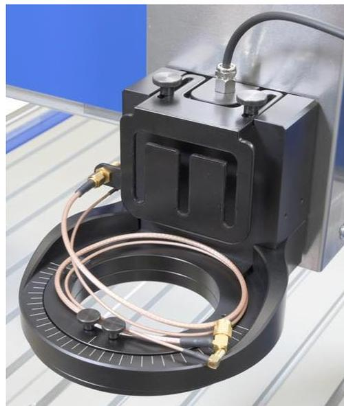
Bild 74: Kabel SSMB-SSMB auf dem Drehring
