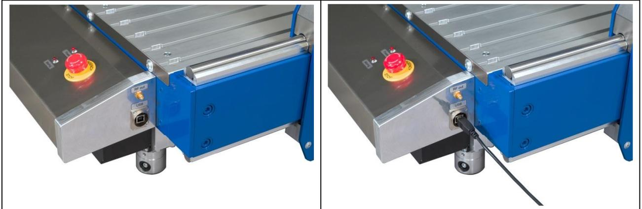
Bild 50: Anschluss des USB-Typ-B-Steckers an den USB-Typ-B-Anschluss des Scanners
