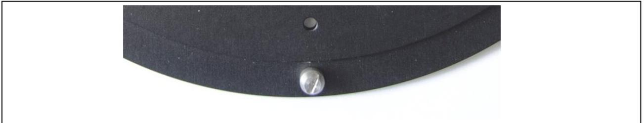
Bild 69: Ausschnitt des GND 25 Halters mit Verdrehschutz
