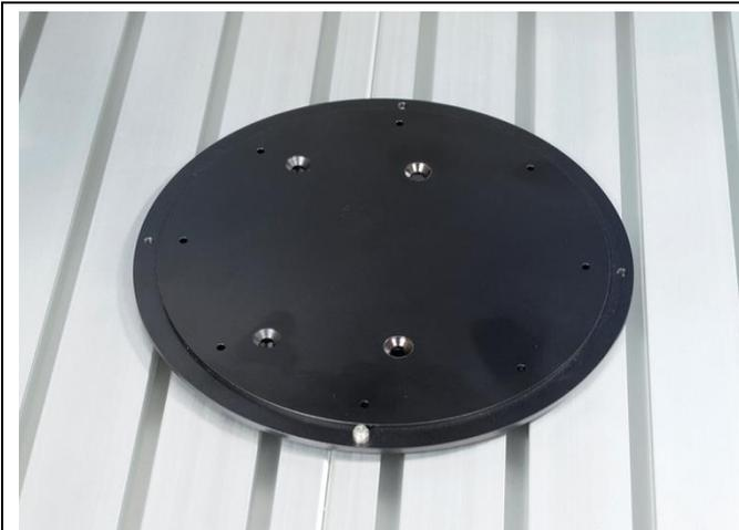
Bild 31: GND 25 Halter auf T-Nutenplatte
