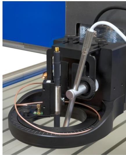
Bild 92: Nahfeldsonde mit Sondenhülse installiert
