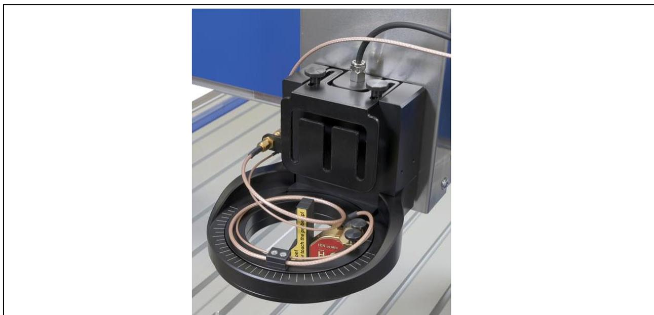
Bild 80: Mit Rändelschrauben befestigte ICR-Sonde
