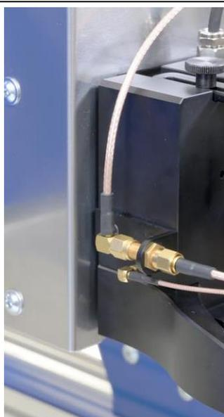
Bild 75: Messkabel SMA-SMA RA an der SMA-Kupplung anschliessen
