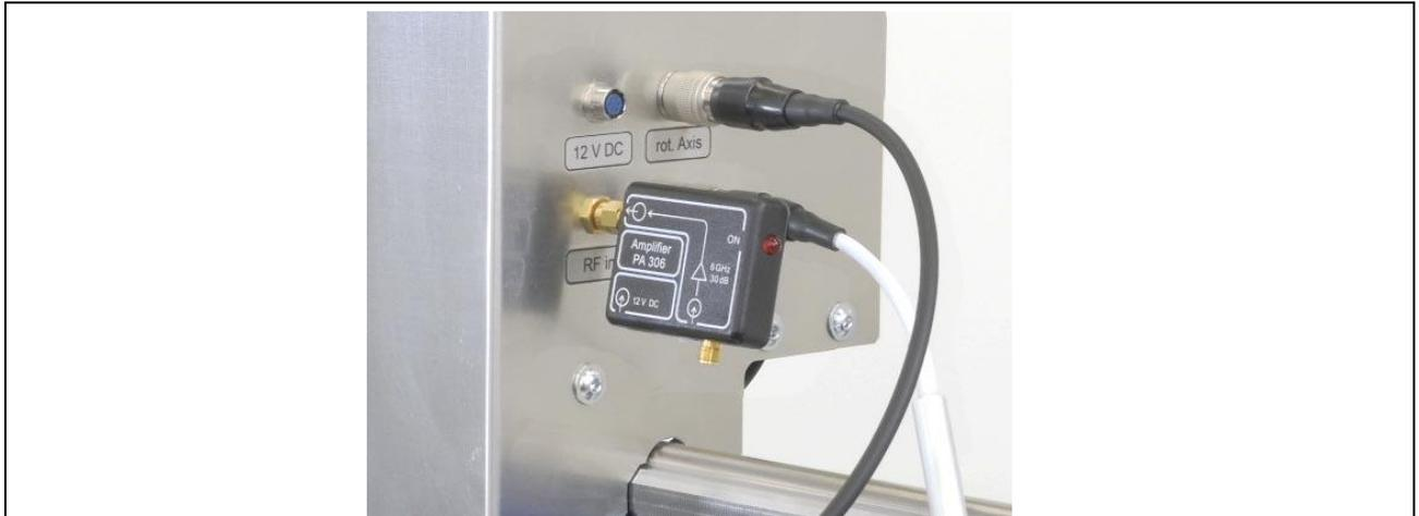
Bild 106: Vorverstärker am „RF in“-Eingang des Scanners
