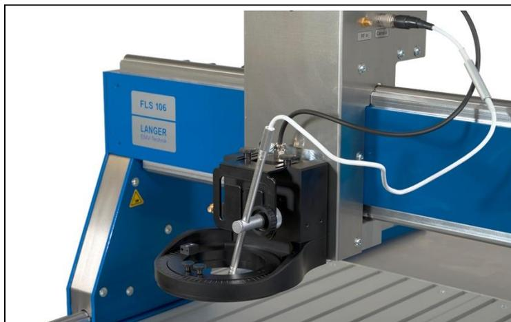
Bild 44: Installierte digitale Mikroskopkamera DM-CAM mit Kabel am Z-Achsenturm angeschlossen
