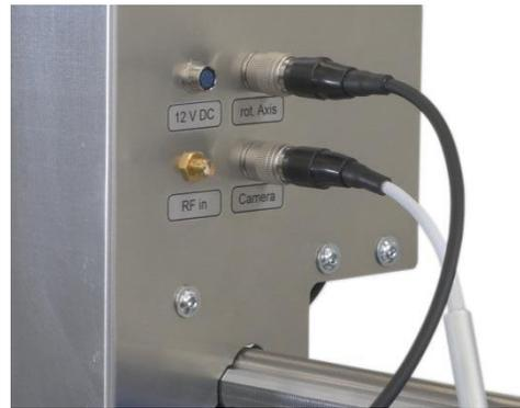
Bild 48: Anbringen des HR10-Stecker der DM-CAM am Anschluss „Camera“ des Z-Achsenturmes
