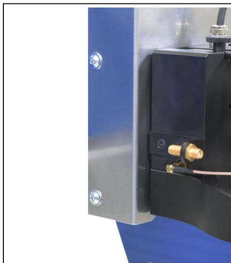
Bild 87: Kabel SSMB-SSMB zur Kollisionskontrolle angeschlossen am Anschlussstecker der Dreheinheit
