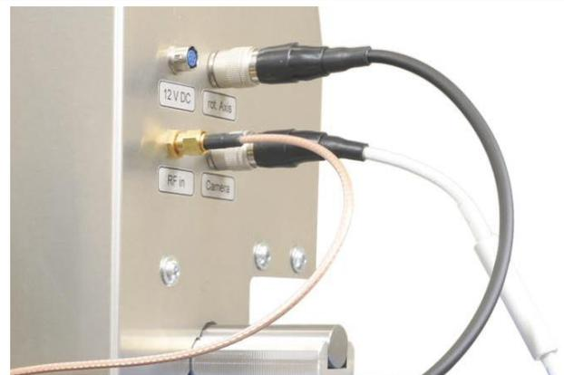
Bild 97: Kabel SMA-SMA RA am Anschluss „RF in“ am Z-Achsenturm
