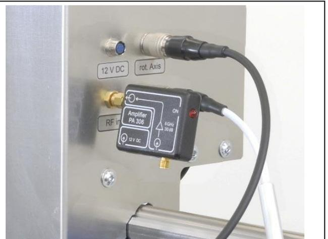
Bild 99: Vorverstärker am „RF in“-Eingang des Scanners
